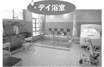
これまで大浴槽と機械浴槽が別の浴室になっていましたが一室としました。カーテンで仕切ることによってプライバシーを確保します。浴室が小さくなった分は外側に濡縁スペースを設け開放感を演出しています。効果的に手すりやカウンターを配置することで洗身しやすさと安全面に配慮しています。
